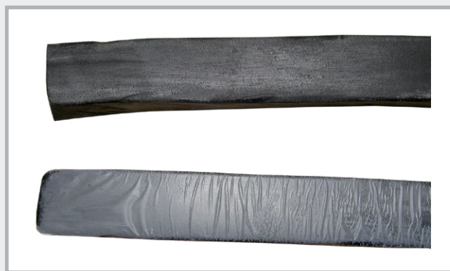
Vergleich Quellband mit und ohne Schutzhülle
